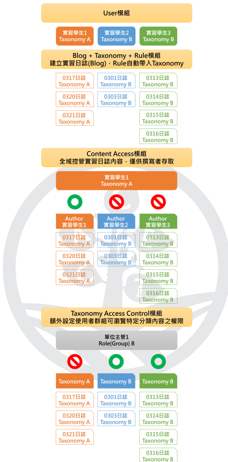
圖 2 系統模組架構圖
